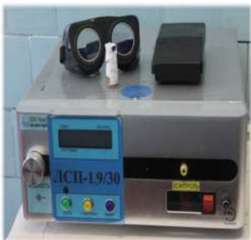
Рис. 3 – оптоволоконный лазер ЛСП 1,9/30
